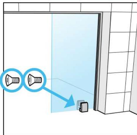
3. Une fois les moulures et le support de sol installés, placez la vitre sur ces moulures et ce support de sol. La partie arrière du support de sol doit être serrée avec des vis. Placez la vitre de sorte qu'elle soit à environ 25 mm du sol et à environ 10 mm à l'intérieur des moulures.
