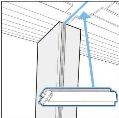
1. Percez des trous dans la moulure pour accueillir les vis de montage, le long des lattes, avec un pas de 600 mm si la poutre est uniforme.
